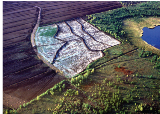
Figure 2. Photo aérienne du site de restauration d'Inkerman Ferry au Nouveau-Brunswick. Les digues ont été disposées le long des courbes de niveau obtenues par un relevé topographique.
