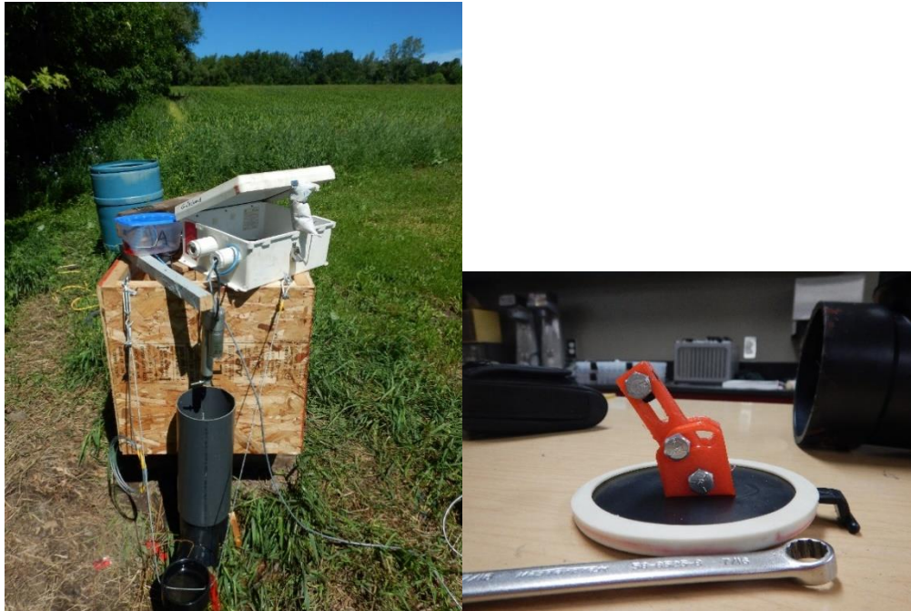
Figure 29 Banc d'essai et le clapet à angle et bras de levier ajustable.
