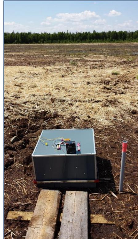
Fig. G. Une chambre de mesure des gaz dans le secteur restauré de la tourbière de Seba Beach en 2013 / Seba Beach restored sector with a chamber for gas measurements in 2013. Photo: M. Strack.
