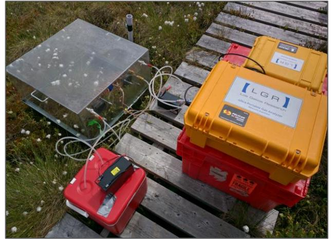
Fig. H. Mesure des flux de CO<sub>2</sub> et de CH<sub>4</sub> à l'aide d'un analyseur portable LGR. / Chamber flux measurements using a LGR CO<sub>2</sub>/CH<sub>4</sub> analyzer (Ultraportable Greenhouse Gas Analyzer). Photo: K. Nugent.
