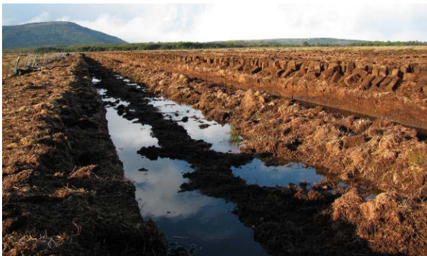
Extraction de la tourbe par coupe mécanique de blocs et séchage à l'air libre.
